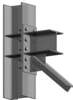
b. Collegamento trave-colonna con controvento
