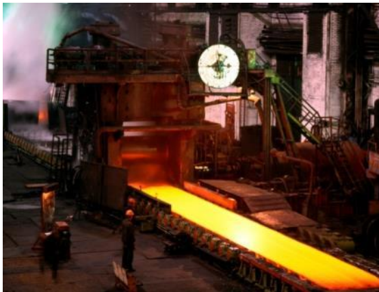
Figure 18 Laminazione a caldo: tipico esempio di treno di laminazione e schematizzazione del processo
