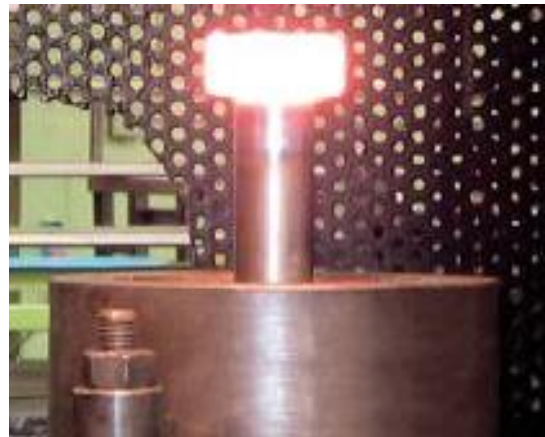
Figure 47 Particolare di stampaggio a caldo della vite (RCZ Bulloneria s.r.l.)
