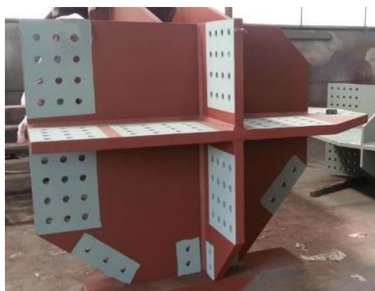
Figura 9 Elementi in acciaio per assemblaggio mediante collegamenti bullonati (stabilimento Cimolai – Pordenone)
