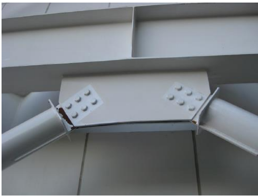
Figura 8 Tipici esempi di rottura di collegamenti ( Effects of the 2011 Tohoku Japan Earthquake on Steel Structures, EERI )
