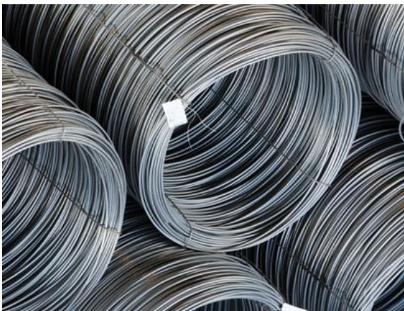
Figure 46 Fornitura di aspi di vergelle in officina
